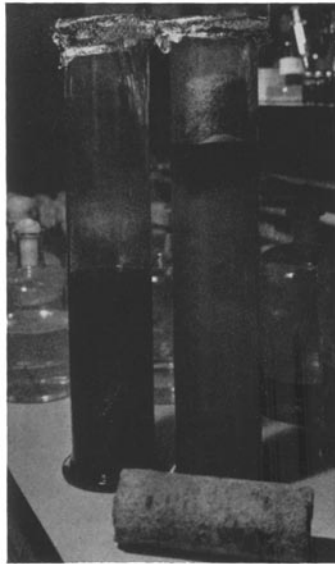
Abb. 4: Das in einem Bohrkern enthaltene Öl dient hier als Kohlenstoffquelle für Desulfovibrio desulfuricans . Die Vergleichskultur links verwendet Calciumlactat als C-Quelle
