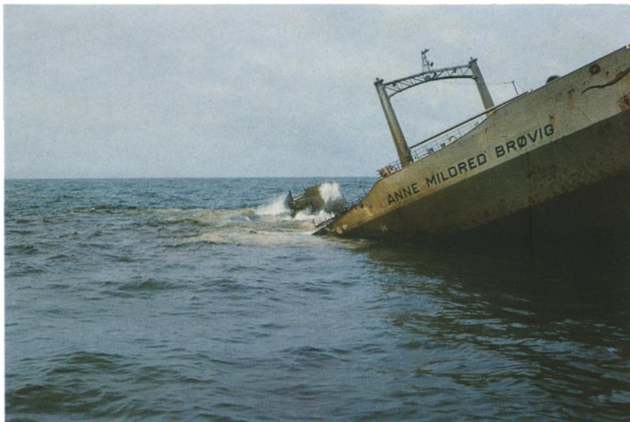
Abb. D2: Der Tanker „Anne Mildred Brøvig“ liegt mit dem Achterschiff auf Grund, während das Vorschiff auf der Ladung schwimmt. Der Ölaustritt ist deutlich an der bräunlichen Färbung und der Beruhigung der Wellen zu erkennen (Photo: REUTERS)
