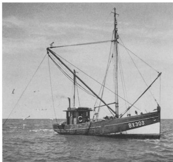
Abb. 2: Krabbenkutter aus Bremerhaven beim Fang mit 2 Schleppnetzen
